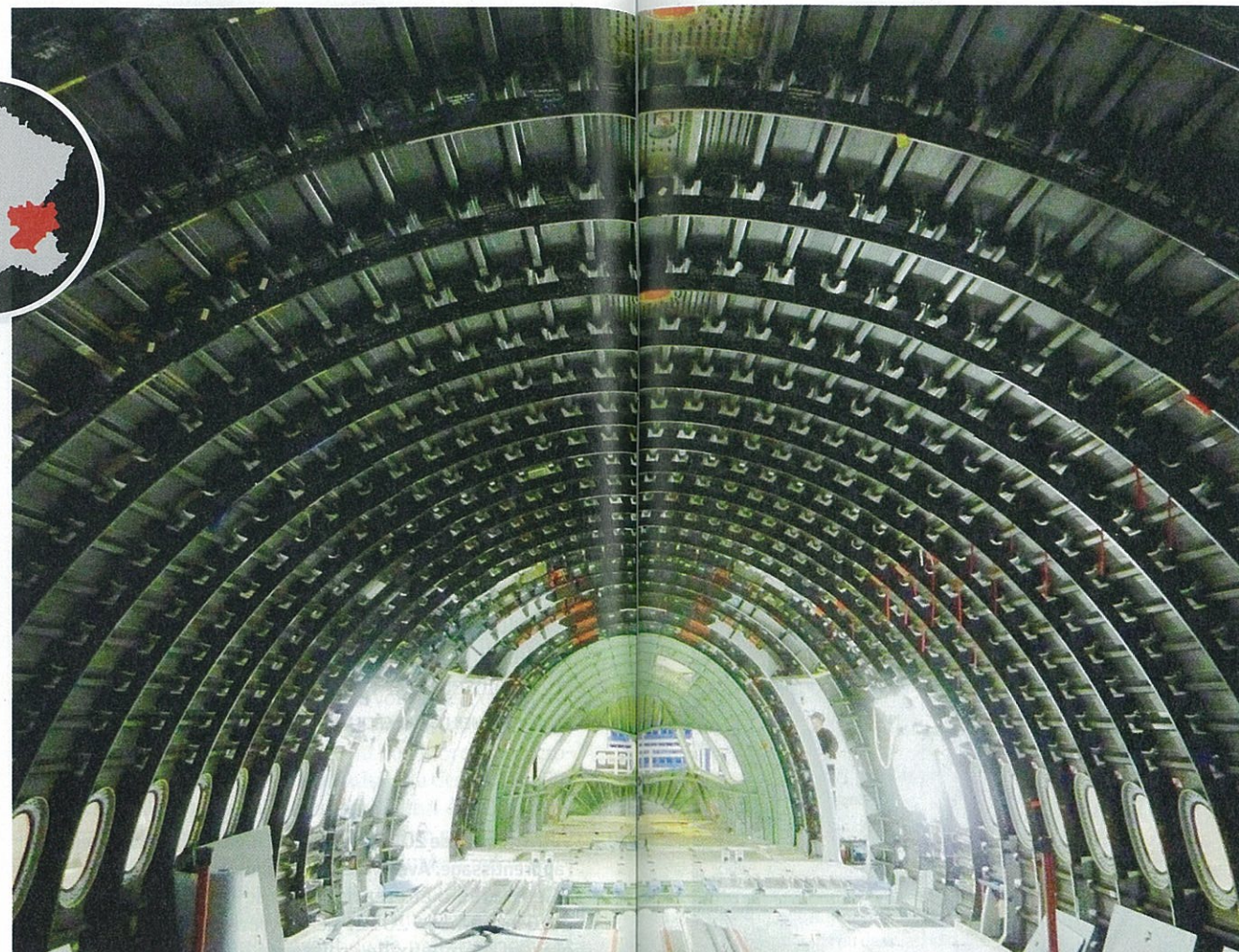
Les cadres de fuselage pour l'Airbus A350 fabriqués par Duqueine.
